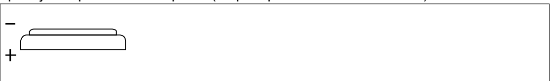
Polariteit van de reservebatterij
