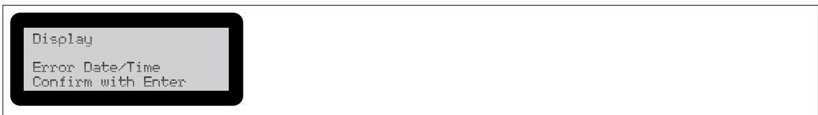
Foto 8.3/1: Foutmelding bij lege batterij
