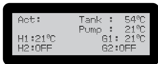
Foto 3.3.3/2: Weergave na het indrukken van de info-toets (voorbeeld)
